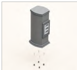
Fixação do Totem diretamente no piso.
